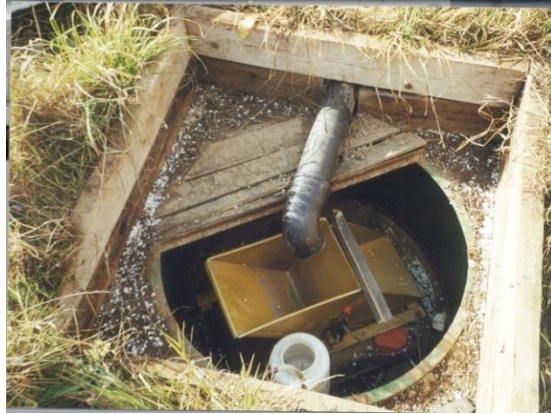
1.3. att. Svārstīgie kausiņi virszemes noteces mērīšanai Mellupītes monitoringa stacijā.
