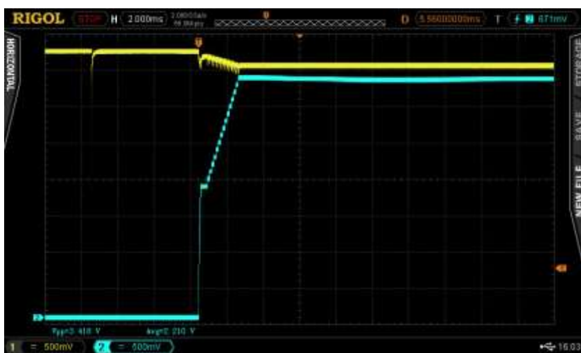
Att. 43. Ieslēgšana ar bateriju, ieslēdzot ar jaudas slēdzi un ar 35,7\Omega slodzi. Baterijas spriegums – dzeltens, slodzes spriegums – zils.
