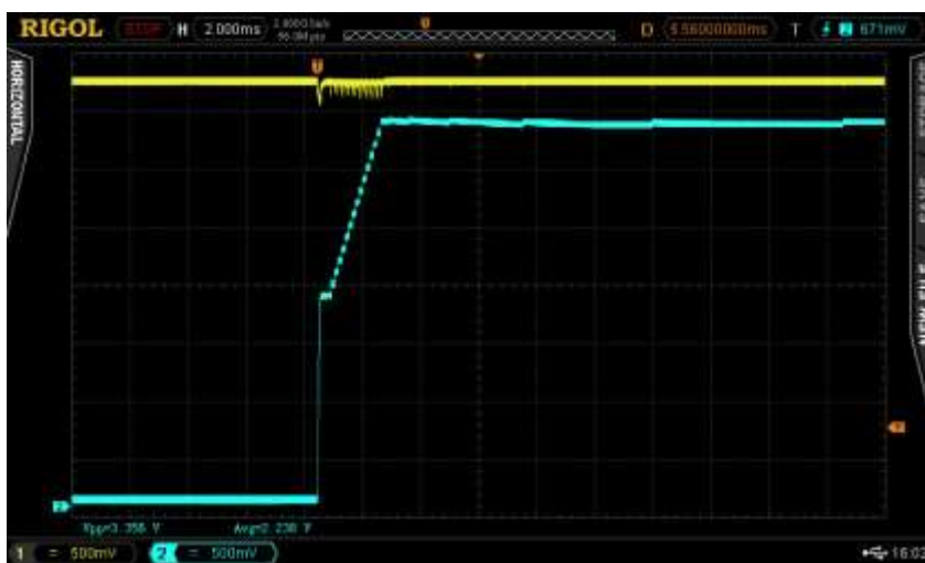
Att. 42. Ieslēgšana ar bateriju, ieslēdzot ar regulatoru, tukšgaitā. Baterijas spriegums – dzeltens, slodzes spriegums – zils.
