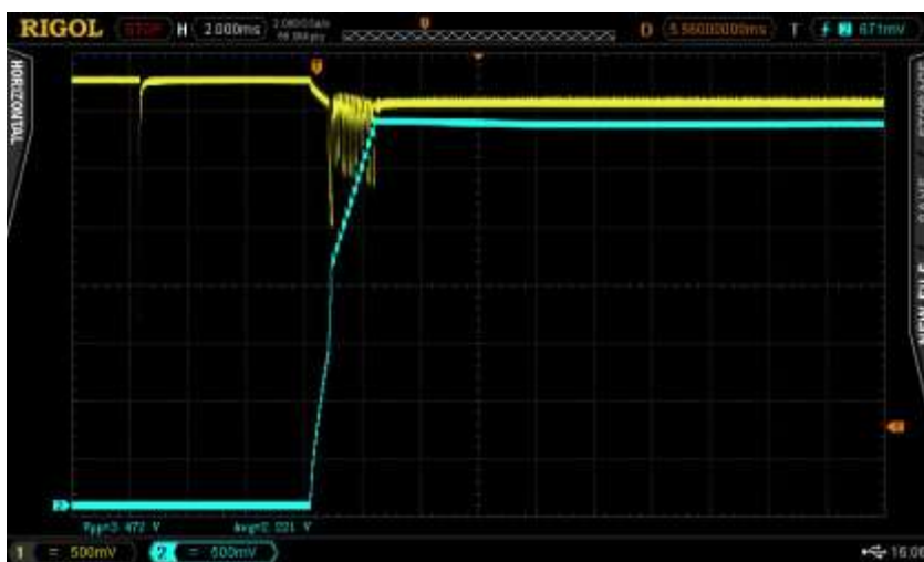
Att. 45. Ieslēgšana ar bateriju, ieslēdzot ar jaudas slēdzi un ar 35,7\Omega+100\mu\text{F} slodzi. Baterijas spriegums – dzeltens, slodzes spriegums – zils.
