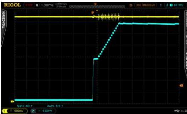
Att. 14. Ieslēgšana ar barošanas bloku, ieslēdzot ar regulatoru, tukšgaitā. Barošanas bloka spriegums – dzeltens, slodzes spriegums – zils.
