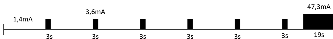
Att. 2.3.27. Baterijas vienas stundas slodzes profils.
