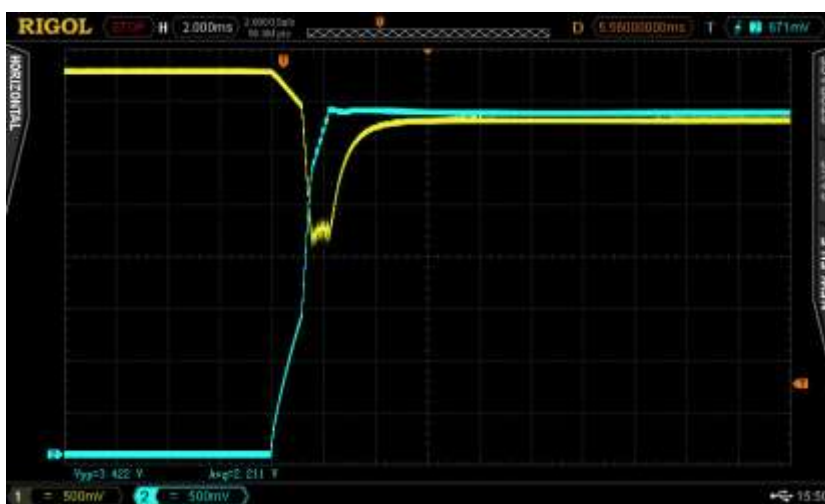
Att. 40. Ieslēgšana ar bateriju+300 \mu F, ieslēdzot ar regulatoru un ar 35,7 \Omega +200 \mu F slodzi. Baterijas spriegums – dzeltens, slodzes spriegums – zils.
