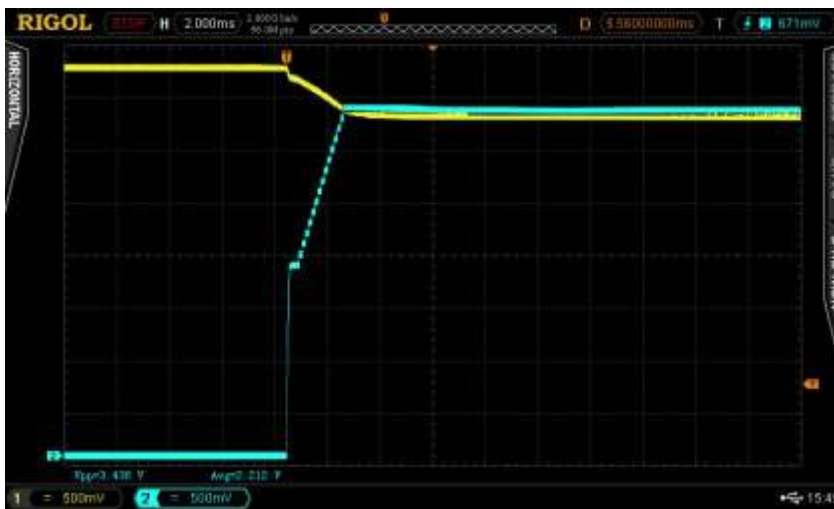
Att. 36. Ieslēgšana ar bateriju+300 \mu F, ieslēdzot ar regulatoru un ar 35,7 \Omega slodzi. Baterijas spriegums – dzeltens, slodzes spriegums – zils.
