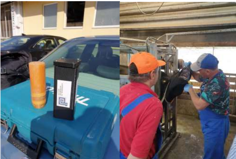
4.1.29. Attēls. Jaunas paaudzes pH un temperatūras mērīšanas boluss. Bola ievietošana dzīvnieka spureklī.
