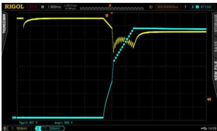
Att. 25. Ieslēgšana ar bateriju+100 \mu F, ieslēdzot ar jaudas slēdzi un ar 35,7 \Omega +100 \mu F slodzi. Baterijas spriegums – dzeltens, slodzes spriegums – zils.
