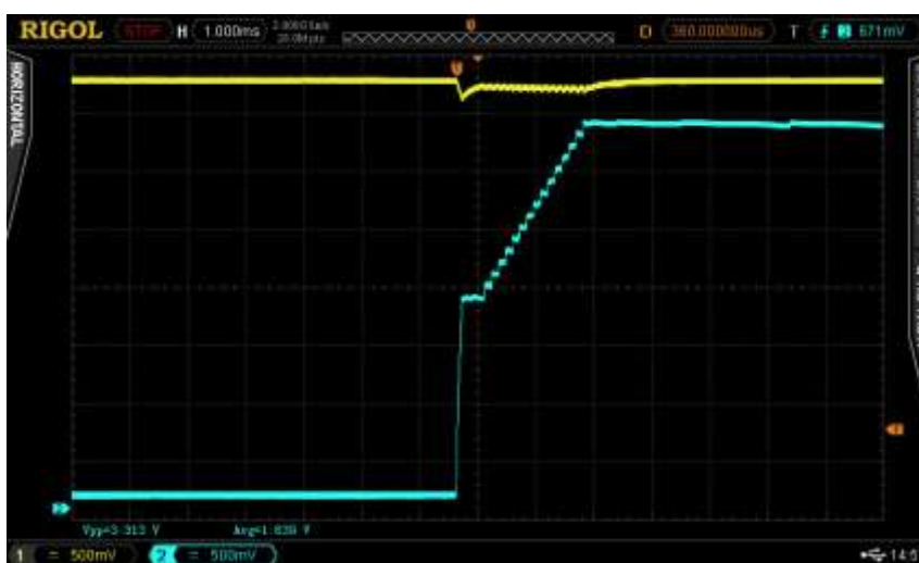
Att. 22. Ieslēgšana ar bateriju+100 \mu F, ieslēdzot ar regulatoru, tukšgaitā. Baterijas spriegums – dzeltens, slodzes spriegums – zils.
