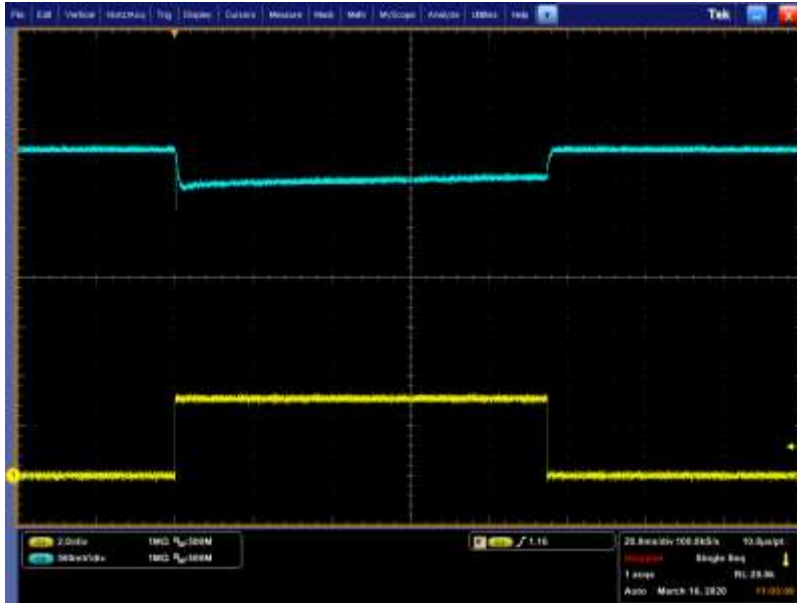
Att. 2.3.9. TCR3UG regulatora izejas spriegums ar Saft LSH14 bateriju ieejā.
