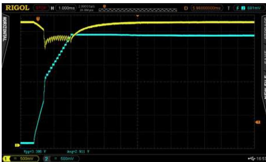
Att. 9. Regulatora izejas sprieguma (zils) un baterijas sprieguma (dzeltens) oscilogramma regulatora palaišanas brīdī ar 100uF slodzi un 100uF paralēli baterijai.
