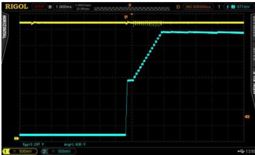
Att. 13. Ieslēgšana ar barošanas bloku, ieslēdzot ar jaudas slēdzi, tukšgaitā. Barošanas bloka spriegums – dzeltens, slodzes spriegums – zils.
