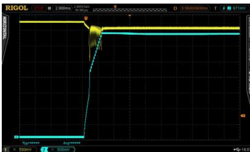
Att. 46. Ieslēgšana ar bateriju, ieslēdzot ar regulatoru un ar 35,7\Omega+100\mu\text{F} slodzi. Baterijas spriegums – dzeltens, slodzes spriegums – zils.
