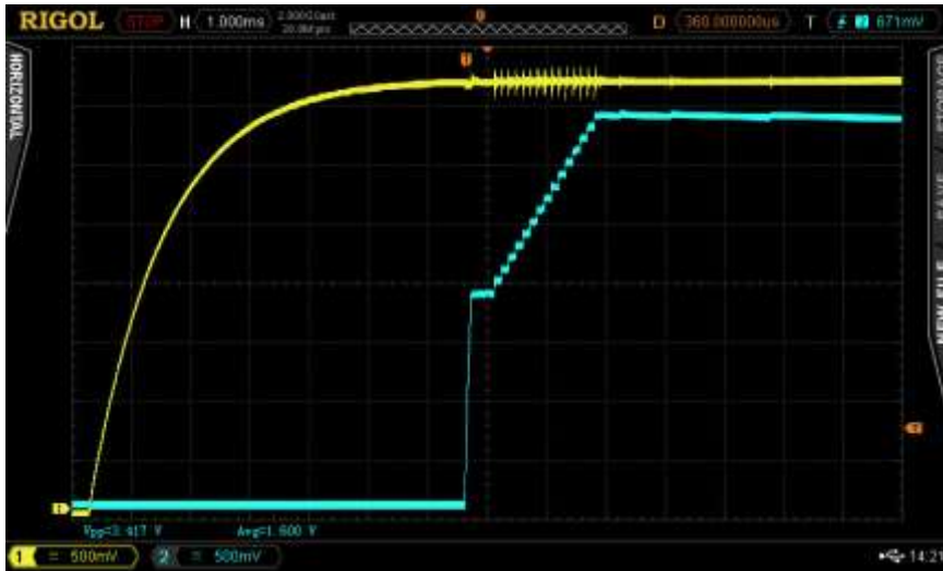
Att. 12. Ieslēgšana, ieslēdzot barošanas bloku, tukšgaitā. Barošanas bloka spriegums – dzeltens, slodzes spriegums – zils.
