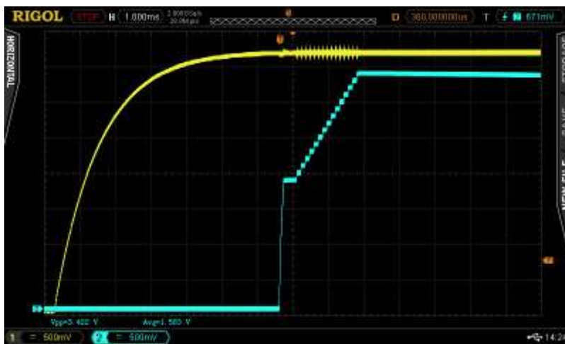
Att. 15. Ieslēgšana, ieslēdzot barošanas bloku un ar 35,7\Omega slodzi. Barošanas bloka spriegums – dzeltens, slodzes spriegums – zils.
