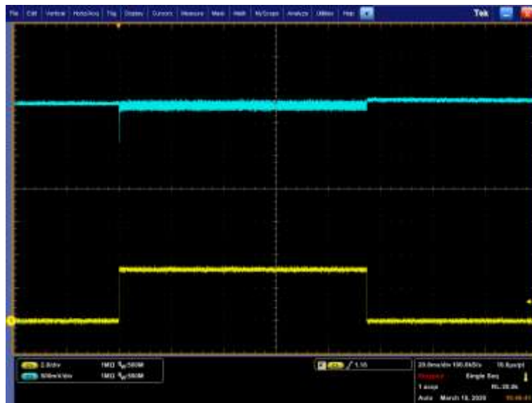
Att. 2.3.6. TCR3UG regulatora izejas spriegums ar barošanas bloku ieejā.
