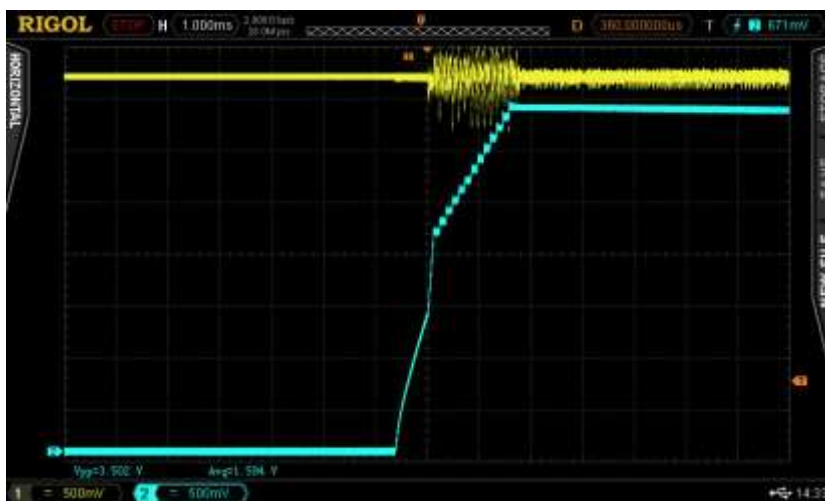
Att. 20. Ieslēgšana ar barošanas bloku, ieslēdzot ar regulatoru un ar 35,7\Omega+100\mu\text{F} slodzi. Barošanas bloka spriegums – dzeltens, slodzes spriegums – zils.
