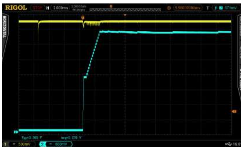
Att. 41. Ieslēgšana ar bateriju, ieslēdzot ar jaudas slēdzi, tukšgaitā. Baterijas spriegums – dzeltens, slodzes spriegums – zils.
