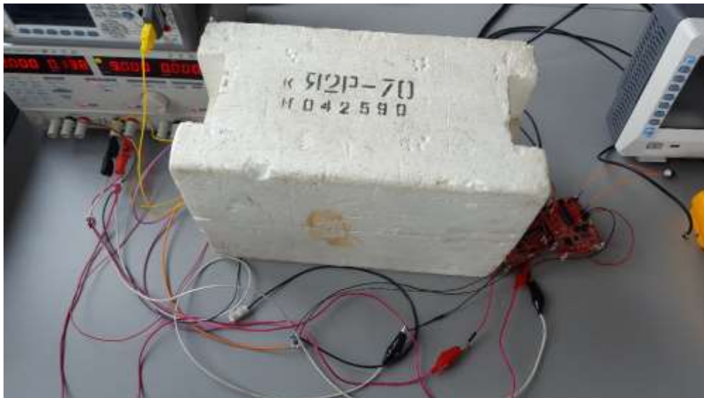
Att. 2.3.19. Temperatūras kambaris ar vadības mikrokontrolleri un citām daļām.
