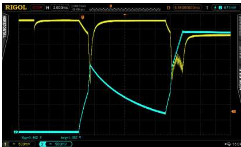
Att. 27. Ieslēgšana ar bateriju+100 \mu F, ieslēdzot ar jaudas slēdzi un ar 35,7 \Omega +200 \mu F slodzi. Baterijas spriegums – dzeltens, slodzes spriegums – zils.
