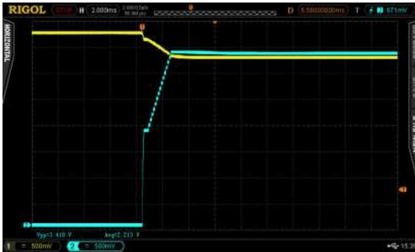
Att. 30. Ieslēgšana ar bateriju+200 \mu F, ieslēdzot ar regulatoru un ar 35,7 \Omega slodzi. Baterijas spriegums – dzeltens, slodzes spriegums – zils.
