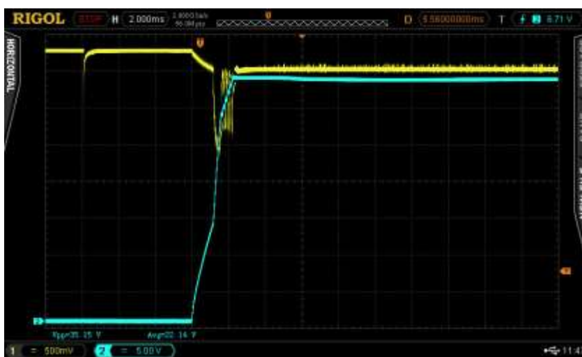
Att. 47. Ieslēgšana ar bateriju, ieslēdzot ar jaudas slēdzi un ar 35,7\Omega+200\mu\text{F} slodzi. Baterijas spriegums – dzeltens, slodzes spriegums – zils.
