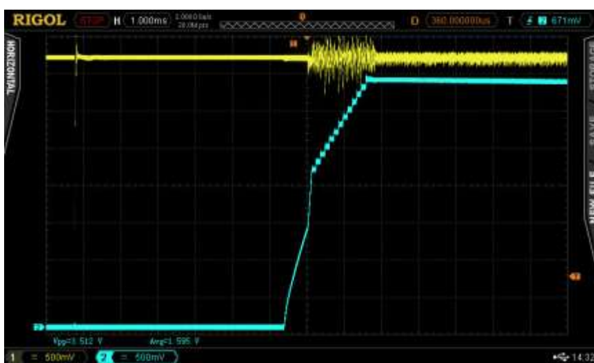
Att. 19. Ieslēgšana ar barošanas bloku, ieslēdzot ar jaudas slēdzi un ar 35,7\Omega+100\mu\text{F} slodzi. Barošanas bloka spriegums – dzeltens, slodzes spriegums – zils.
