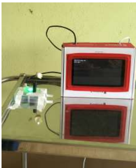
2.2.7. attēls. Bolusa radiosignāla uztvērējs ar attālinātas vadības ierīci
