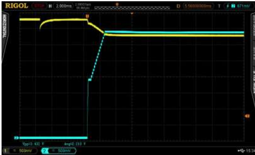
Att. 29. Ieslēgšana ar bateriju+200 \mu F, ieslēdzot ar jaudas slēdzi un ar 35,7 \Omega slodzi. Baterijas spriegums – dzeltens, slodzes spriegums – zils.
