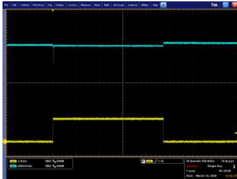
Att. 2.3.7. TCR3UG regulatora izejas spriegums ar EVE ER26500 bateriju ieejā.
