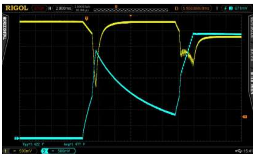
Att. 34. Ieslēgšana ar bateriju+200 \mu F, ieslēdzot ar regulatoru un ar 35,7 \Omega +200 \mu F slodzi. Baterijas spriegums – dzeltens, slodzes spriegums – zils.
