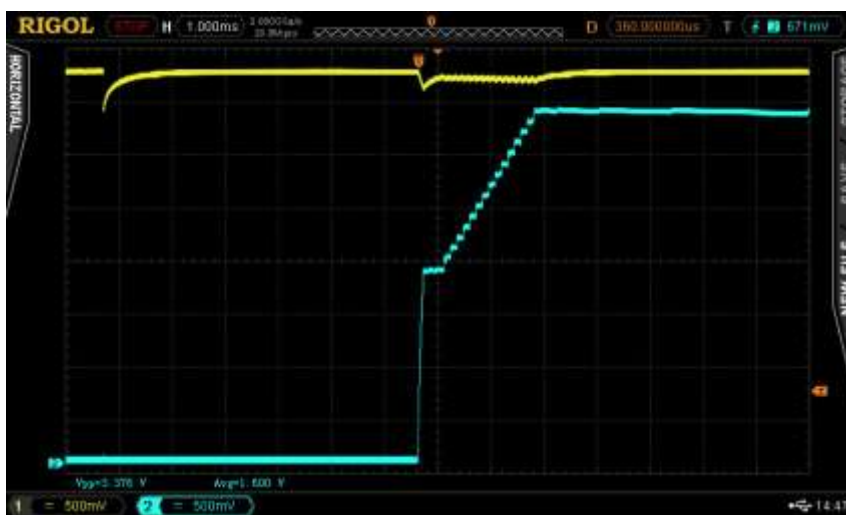
Att. 21. Ieslēgšana ar bateriju+100 \mu F, ieslēdzot ar jaudas slēdzi, tukšgaitā. Baterijas spriegums – dzeltens, slodzes spriegums – zils.
