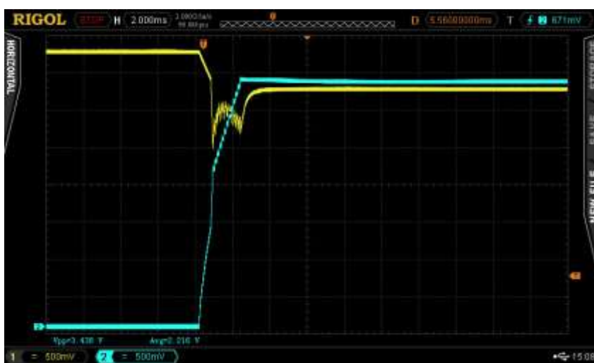
Att. 26. Ieslēgšana ar bateriju+100 \mu F, ieslēdzot ar regulatoru un ar 35,7 \Omega +100 \mu F slodzi. Baterijas spriegums – dzeltens, slodzes spriegums – zils.
