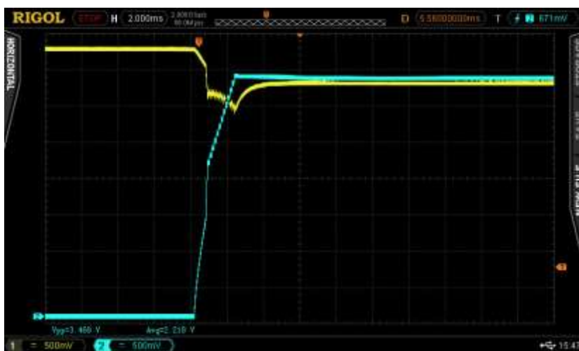
Att. 38. Ieslēgšana ar bateriju+300 \mu F, ieslēdzot ar regulatoru un ar 35,7 \Omega +100 \mu F slodzi. Baterijas spriegums – dzeltens, slodzes spriegums – zils.
