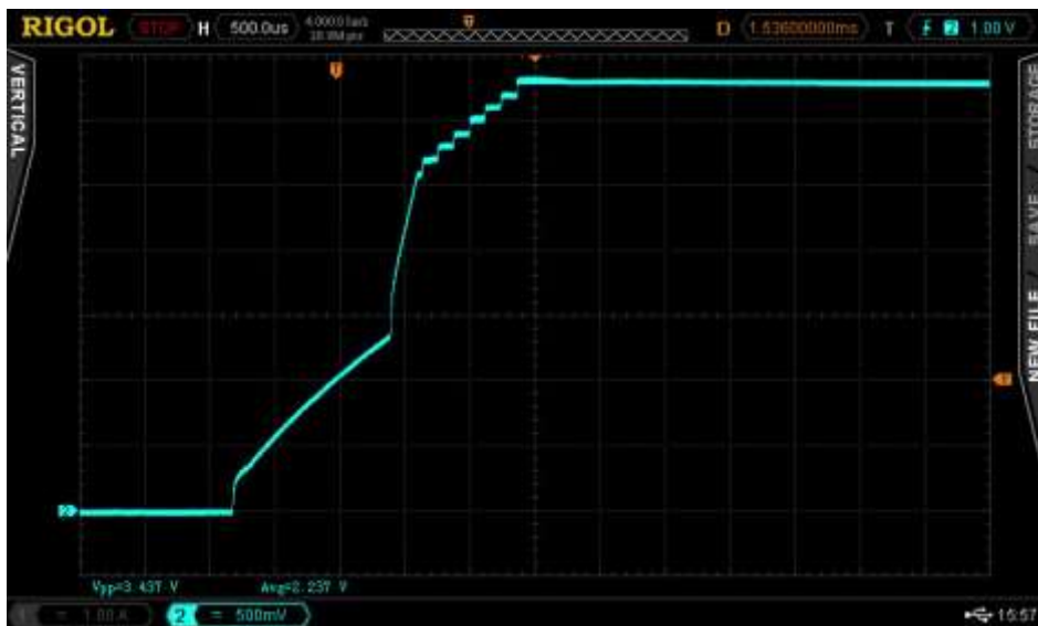
Att. 5. Regulatora izejas spriegums palaišanas procesā pie 18\Omega un 220\mu\text{F} slodzes.
