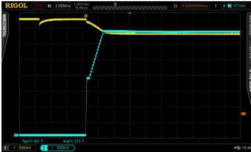
Att. 35. Ieslēgšana ar bateriju+300 \mu F, ieslēdzot ar jaudas slēdzi un ar 35,7 \Omega slodzi. Baterijas spriegums – dzeltens, slodzes spriegums – zils.
