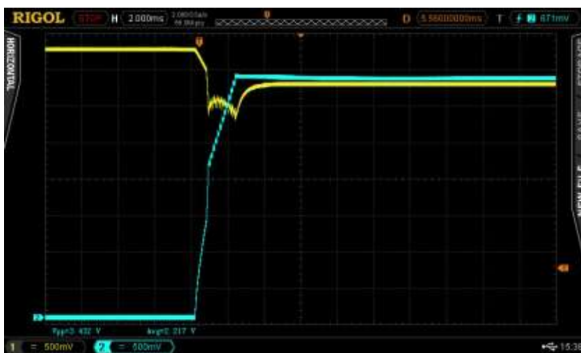
Att. 32. Ieslēgšana ar bateriju+200 \mu F, ieslēdzot ar regulatoru un ar 35,7 \Omega +100 \mu F slodzi. Baterijas spriegums – dzeltens, slodzes spriegums – zils.
