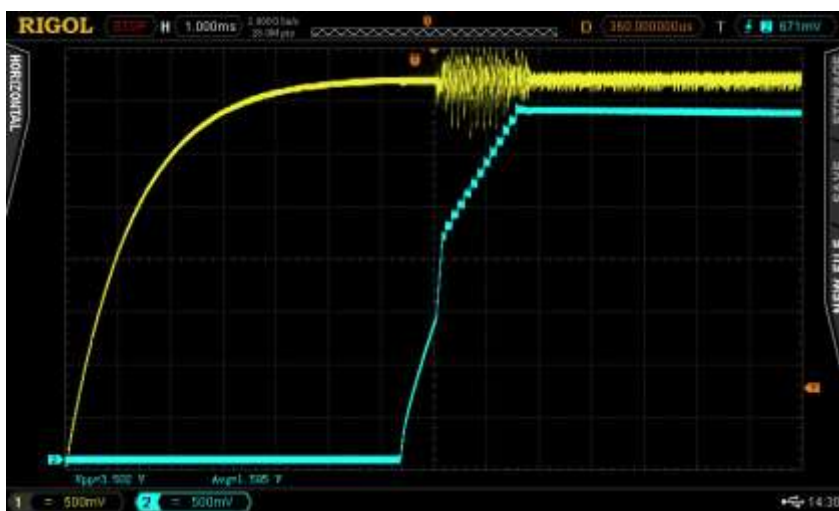
Att. 18. Ieslēgšana, ieslēdzot barošanas bloku un ar 35,7\Omega+100\mu\text{F} slodzi. Barošanas bloka spriegums – dzeltens, slodzes spriegums – zils.
