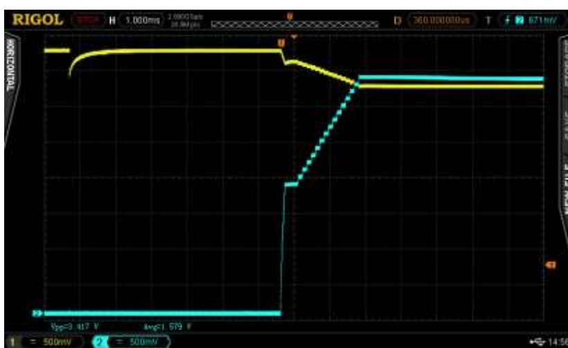
Att. 23. Ieslēgšana ar bateriju+100 \mu F, ieslēdzot ar jaudas slēdzi un ar 35,7 \Omega slodzi. Baterijas spriegums – dzeltens, slodzes spriegums – zils.
