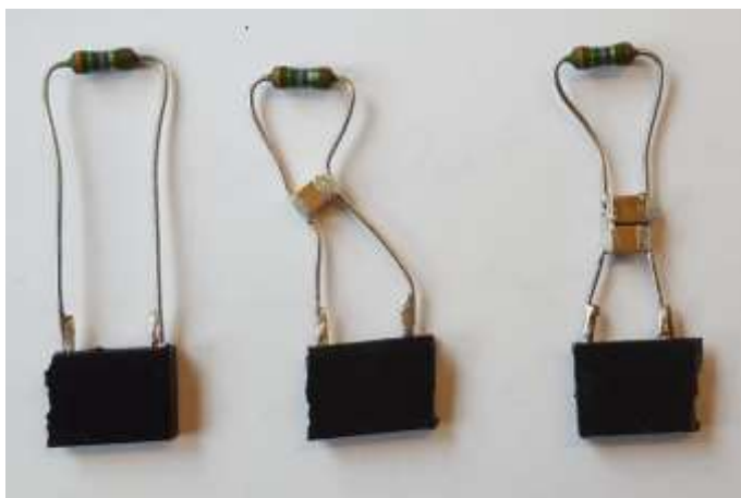
Att. 11. Testa slodzes, kuras sastāvēja no 35,7\Omega rezistora un diviem 100\mu\text{F} kondensatoriem.
