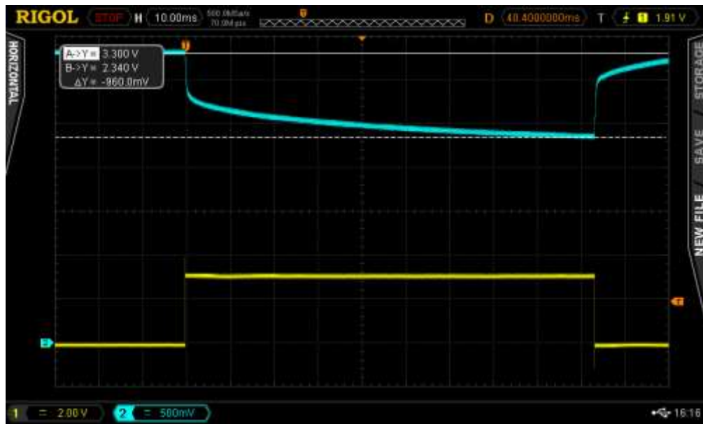
Att. 2.3.25. Baterijas (Fanso ER18505M) izlādes impulss 20.10.2020.
