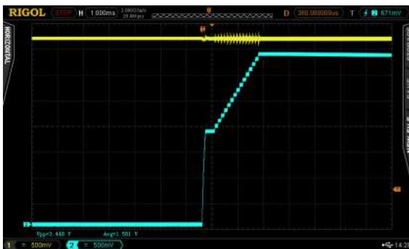
Att. 17. Ieslēgšana ar barošanas bloku, ieslēdzot ar regulatoru un ar 35,7\Omega slodzi. Barošanas bloka spriegums – dzeltens, slodzes spriegums – zils.
