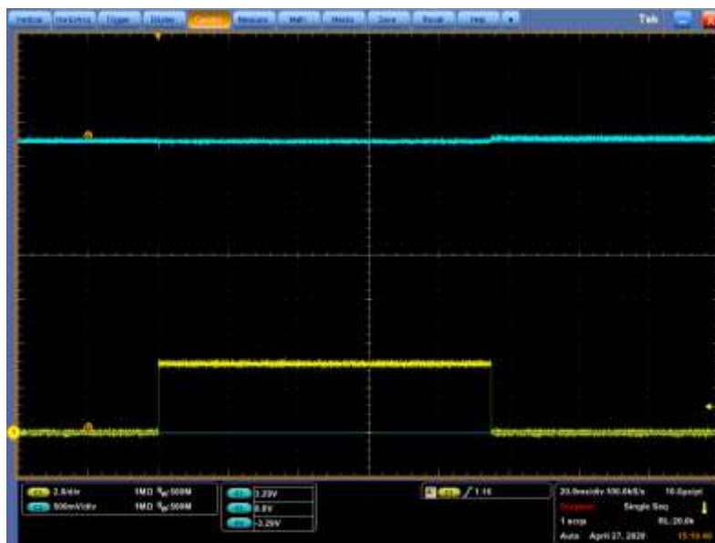
Att. 2.3.11. NCV8170 impulsa slodzes tests ar barošanas bloku.
