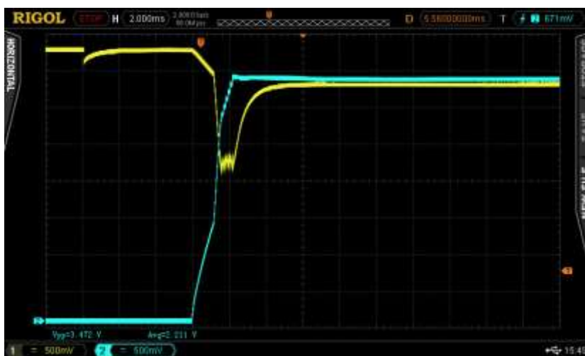
Att. 39. Ieslēgšana ar bateriju+300 \mu F, ieslēdzot ar jaudas slēdži un ar 35,7 \Omega +200 \mu F slodzi. Baterijas spriegums – dzeltens, slodzes spriegums – zils.
