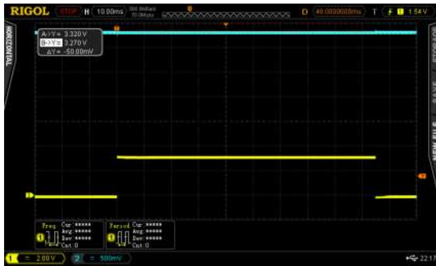
Att. 2.3.15. impulsa izlādes process.
