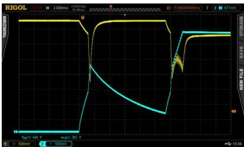
Att. 28. Ieslēgšana ar bateriju+100 \mu F, ieslēdzot ar regulatoru un ar 35,7 \Omega +200 \mu F slodzi. Baterijas spriegums – dzeltens, slodzes spriegums – zils.
