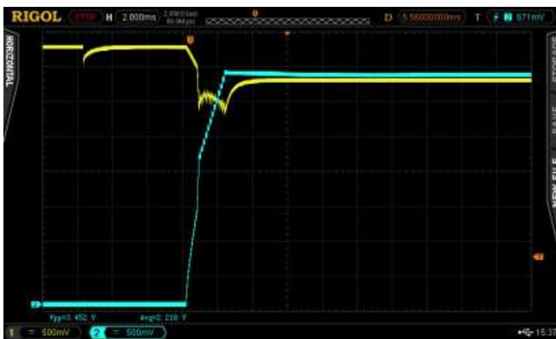
Att. 31. Ieslēgšana ar bateriju+200 \mu F, ieslēdzot ar jaudas slēdzi un ar 35,7 \Omega +100 \mu F slodzi. Baterijas spriegums – dzeltens, slodzes spriegums – zils.
