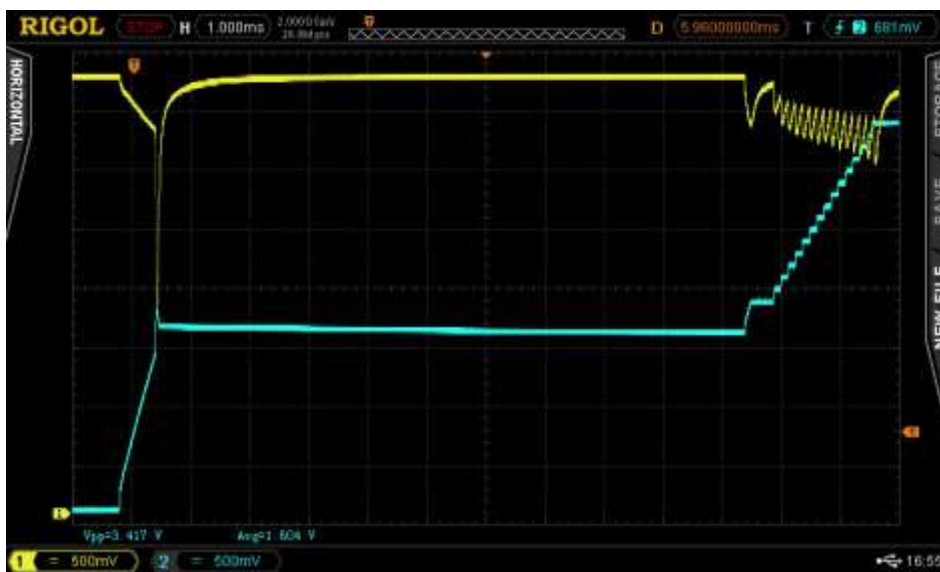
Att. 8. Regulatora izejas sprieguma (zils) un baterijas sprieguma (dzeltens) oscilogramma regulatora palaišanas brīdī ar 100uF slodzi.
