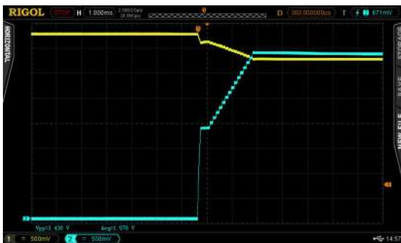
Att. 24. Ieslēgšana ar bateriju+100 \mu F, ieslēdzot ar regulatoru un ar 35,7 \Omega slodzi. Baterijas spriegums – dzeltens, slodzes spriegums – zils.
