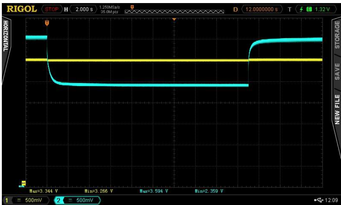
Att. 2.3.42. Baterijas (zils) un izejas (dzeltens) spriegums garajā izlādē 22. novembrī.
