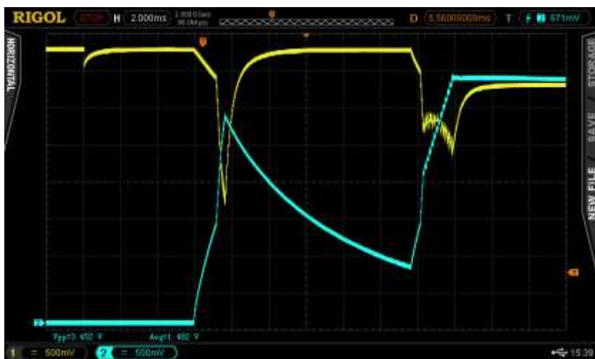
Att. 33. Ieslēgšana ar bateriju+200 \mu F, ieslēdzot ar jaudas slēdzi un ar 35,7 \Omega +200 \mu F slodzi. Baterijas spriegums – dzeltens, slodzes spriegums – zils.
