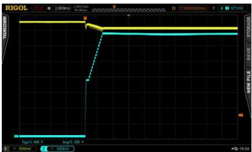
Att. 44. Ieslēgšana ar bateriju, ieslēdzot ar regulatoru un ar 35,7\Omega slodzi. Baterijas spriegums – dzeltens, slodzes spriegums – zils.
