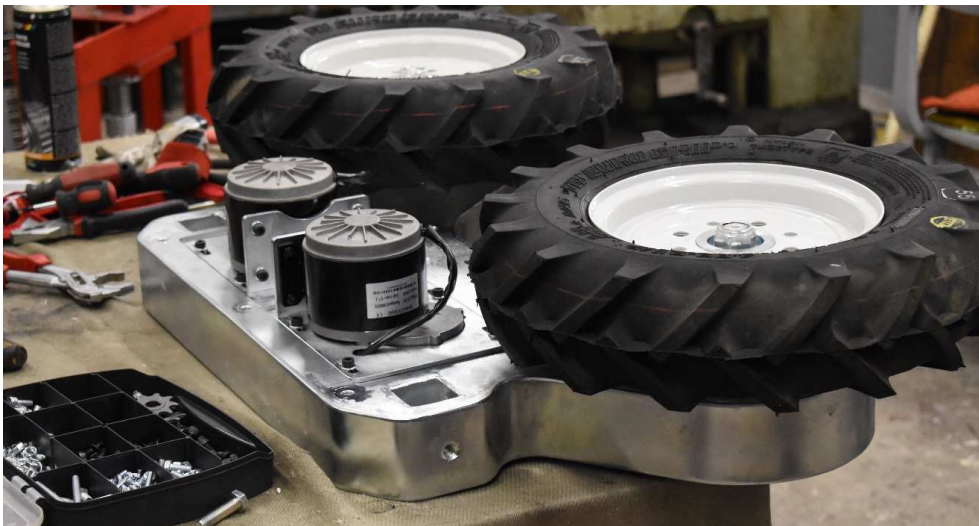
107. att. Samontēts sānu piedziņas bloks.
