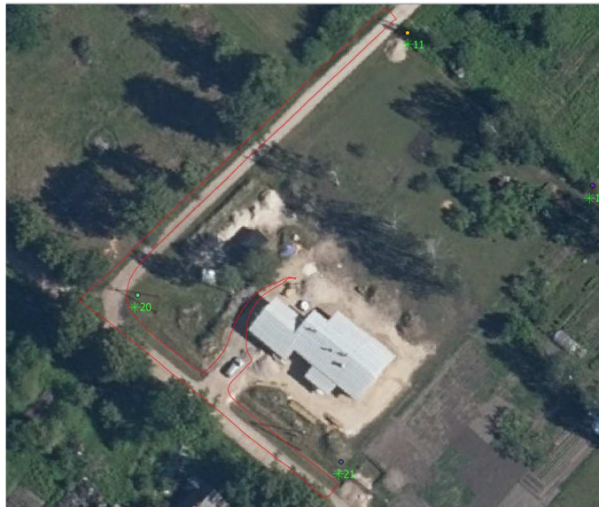
87. att. GNSS RTK precizitātes testi - novērojama konstanta koordinātu nobīde X un Y ass virzienā.
