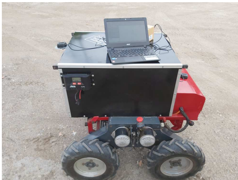
94. att. Satelītnavigācijas algoritmu testi ar V1 platformu
