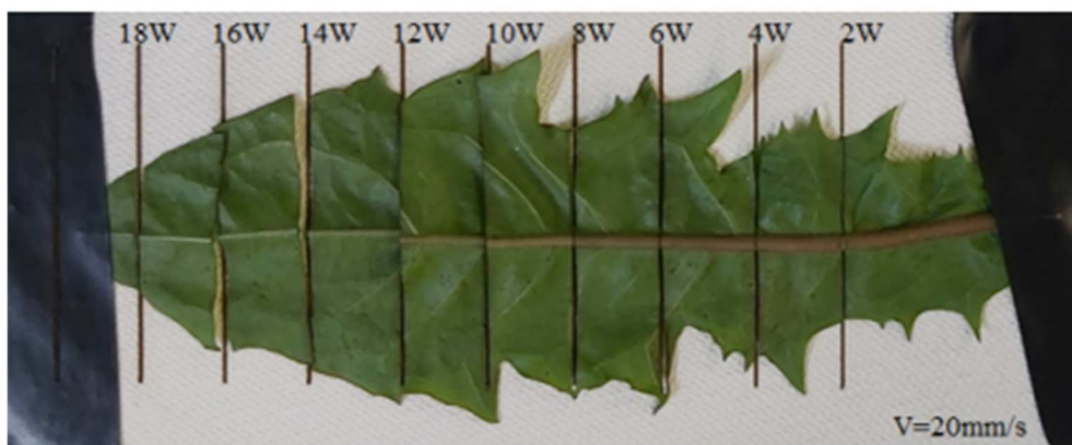
40. att. Lapu apstrādes eksperiments ar CO 2 lāzeri (10600 nm viļņa garums, dažādas jaudas)
