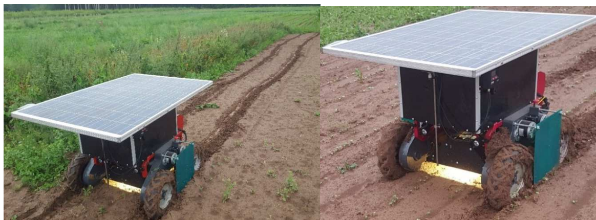
71. att. Pašgājēja fotografēšanas platforma darbībā uz mitras augsnes
