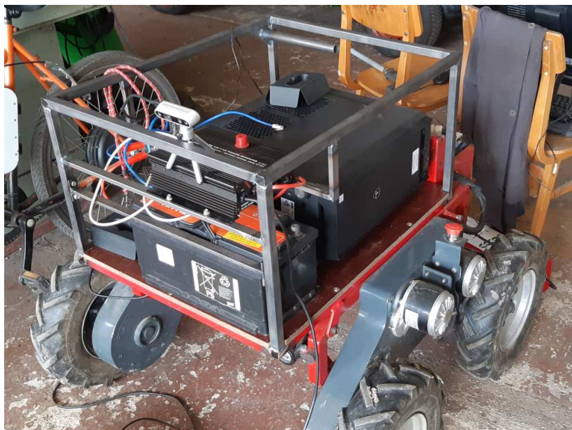
9. att. Korpusa izveide papildaprīkojuma novietošanai.
