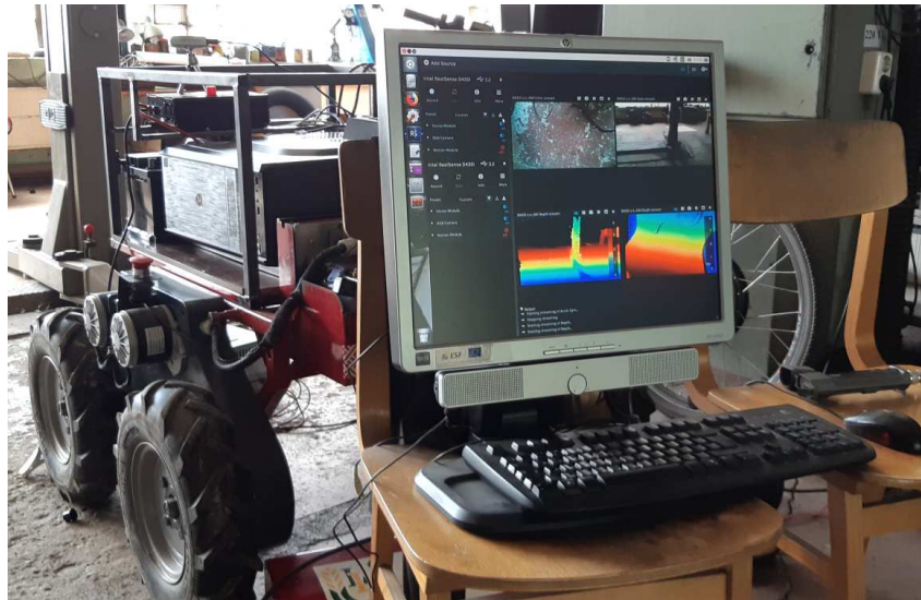
10. att. Augu fotografēšanas kameru salāgošana un pārbaude
