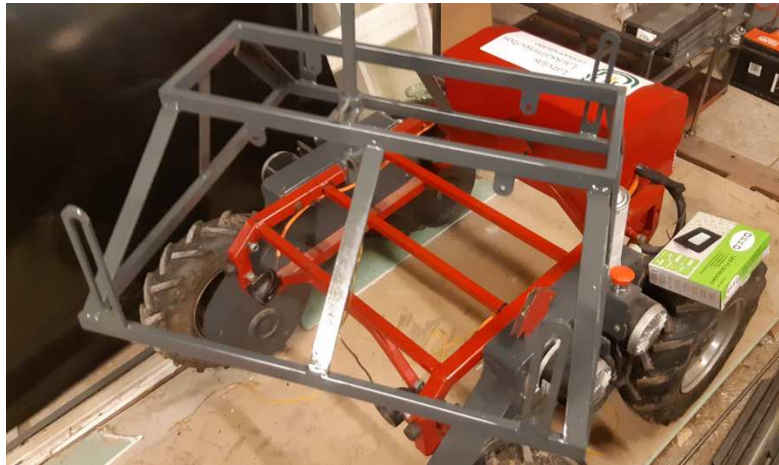
8. att. Kameras un apgaismojuma stiprināšanas rāmja izveide
