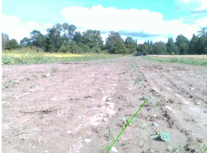
73. att. Ekrānattēls no vagu marķēšanas programmas ar vēlamo robota kustības vektoru
