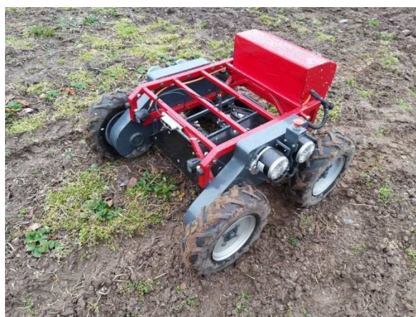
66. att. Pašgājēja fotografēšanas platforma aprīkota ar kamerām un saules aizsegumiem
