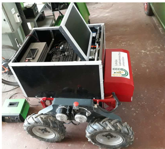
67. att. Platformai uzstādīts attēlu iegūšanas aprīkojuma nodaļums
