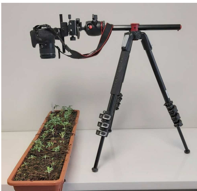
69. att. Fotoaparāts ar statīvu dēstu kastu fotografēšanai
