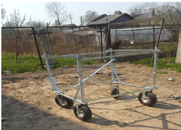
63. att. Stumjamās fotografēšanas platformas karkass
