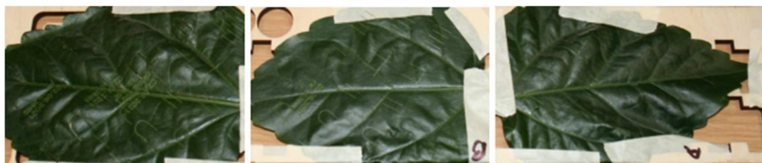
42. att. Lapu apstrādes eksperiments ar 30 W BIMEIGAO CO-A320 lāzergravētāju (10600 nm viļņa garums, 50...100% jauda)
