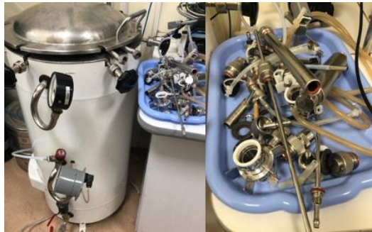
O13. att. Bioreaktora maisītājs pēc sterilizācijas procesa autoklāvā
