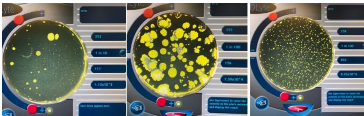
O11. att. Mikroorganismu skaitīšanas piemērs automātiskajā koloniju skaitītājā 1:10 ml un 1:100 ml.
