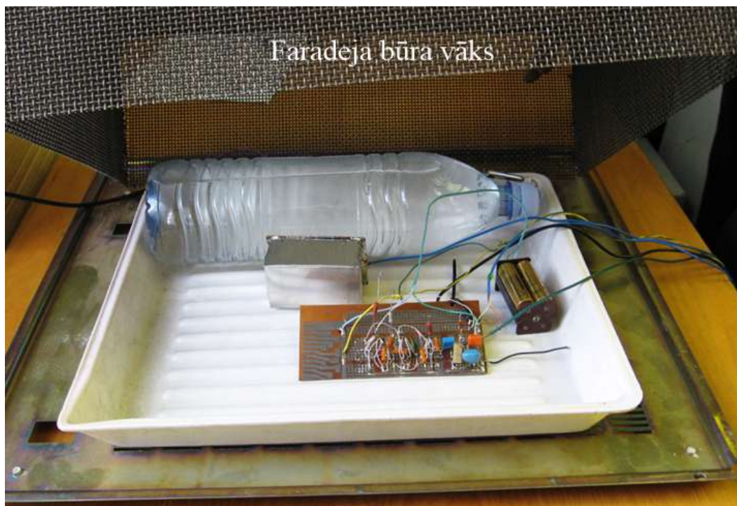
Attēls 4. Konstrukcija Faradeja būrī
