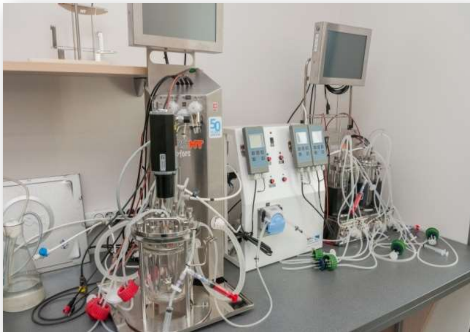
2. attēls. Gastrointestinālā simulācijas iekārta.
