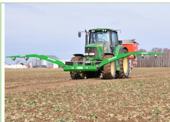
2. attēls. AO GreenSeeker optisko sensoru sistēma slāpekļa izkliešanai
