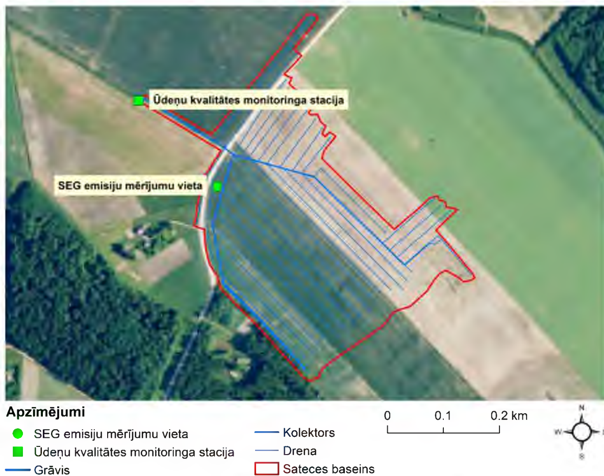
7. att. SEG emisiju mērījumu un ūdeņu paraugu ievākšanas vietas Mellupītes monitoringa stacijā.
