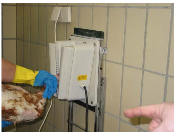
57. attēls. Elektriskā galvas apdullināšanas iekārta un tās pielietošana vistai ( www.efsa.europa.eu )
