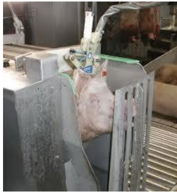
27.attēls. Cūku automātiskās apdullināšanas bokss ( www.alce.at )
